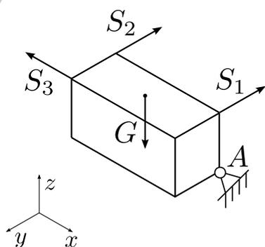
$$\sum \mathbf{M}^A : \begin{pmatrix} 0 \\ 0 \\ a \end{pmatrix} \times \begin{pmatrix} 0 \\ -S_1 \\ 0 \end{pmatrix} + \begin{pmatrix} -3a \\ 0 \\ a \end{pmatrix} \times \begin{pmatrix} 0 \\ -S_2 \\ 0 \end{pmatrix} + \begin{pmatrix} -3a \\ a \\ a \end{pmatrix} \times \begin{pmatrix} -S_3 \\ 0 \\ 0 \end{pmatrix} + \begin{pmatrix} -\frac{3}{2}a \\ \frac{1}{2}a \\ a \end{pmatrix} \times \begin{pmatrix} 0 \\ 0 \\ -G \end{pmatrix} = 0$$
