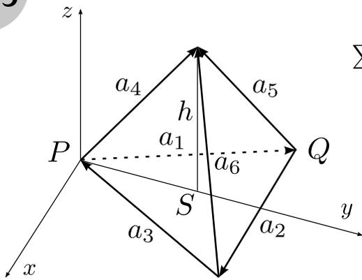
$$\sum \mathbf{M}^P : \begin{pmatrix} 0 \\ \frac{\sqrt{3}}{2}A \\ 0 \end{pmatrix} \times \begin{pmatrix} A \\ 0 \\ 0 \end{pmatrix} + \begin{pmatrix} \frac{1}{2}A \\ \frac{\sqrt{3}}{2}A \\ 0 \end{pmatrix} \times \begin{pmatrix} -\frac{1}{2}A \\ -\frac{1}{2\sqrt{3}}A \\ \sqrt{\frac{2}{3}}A \end{pmatrix} + \begin{pmatrix} -\frac{1}{2}A \\ \frac{\sqrt{3}}{2}A \\ 0 \end{pmatrix} \times \begin{pmatrix} -\frac{1}{2}A \\ -\frac{1}{2\sqrt{3}}A \\ \sqrt{\frac{2}{3}}A \end{pmatrix} = \vec{M}_P$$
